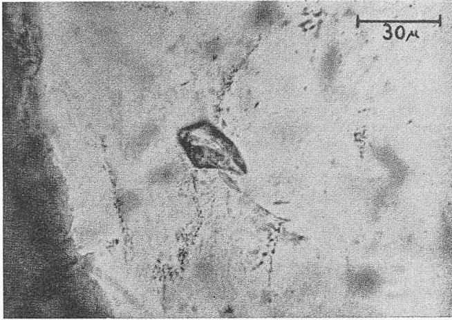
Bild 4. Dünnschliff eines Elba-Granits mit einem Zirkoneinschluss im Polarisationsmikroskop
