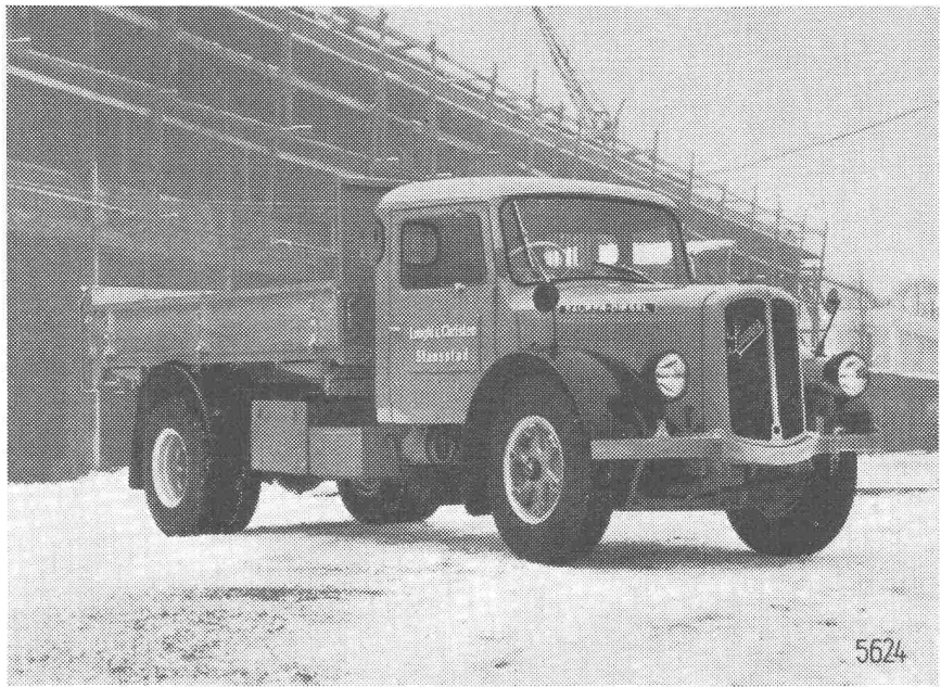
V2C-Dreiseitenkipper für 4 m 3 , mit neuer Kunststoffkabine und Leichtmetall-Brückenladen
