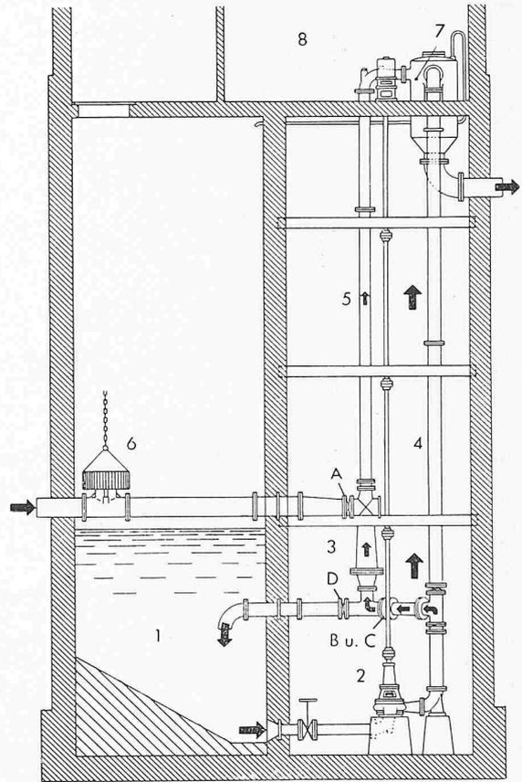
Bild 16 (rechts). Abwasserpumpwerk Langenthal (Schweiz), Anordnung mit Spitzrechen
