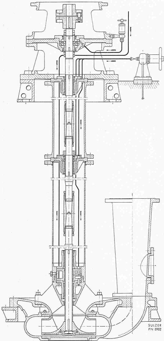
Bild 9 (links). Vertikale Sulzer-Zentrifugalpumpe für das Abwasserwerk Toulouse
