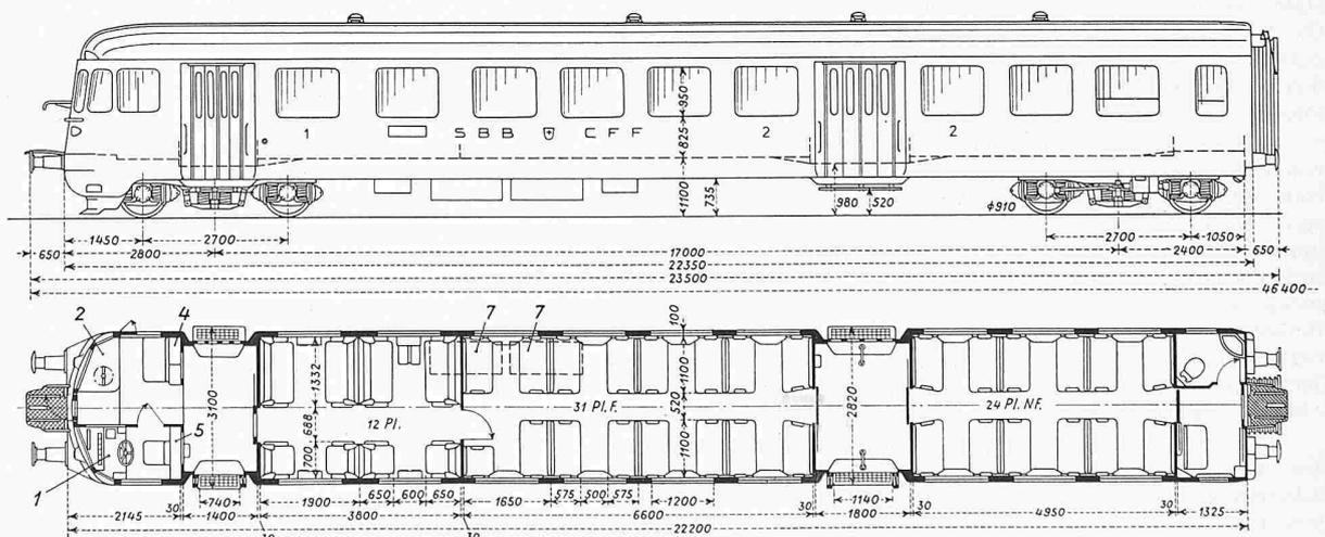
Fig. 2. Vue en élévation, frontalement et en plan, des rames ABFe<sup>4</sup>/<sub>s</sub> nos. 881/981 et 882/982 à courant continu, composées d'une
