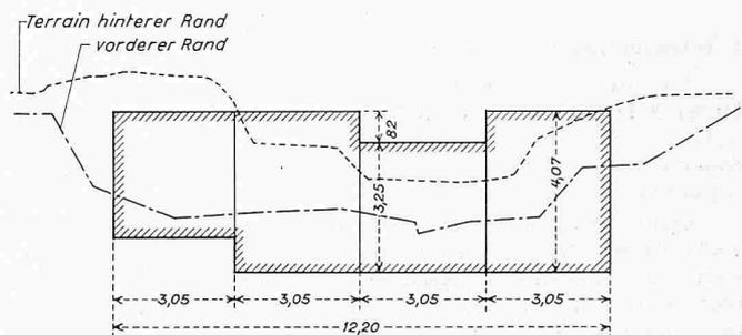
Bild 2. Querprofil des Baches 1:200 mit Eintragung der Sperre
