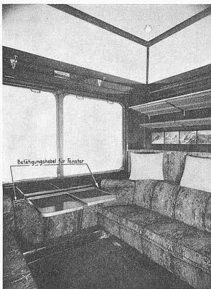
Fig. 1. Compartiment de 1 re classe, avec sièges à oreillers mobiles, d'une voiture lourde des CFF, destinée au trafic international. Dimensionnement particulièrement large, note luxueuse.
