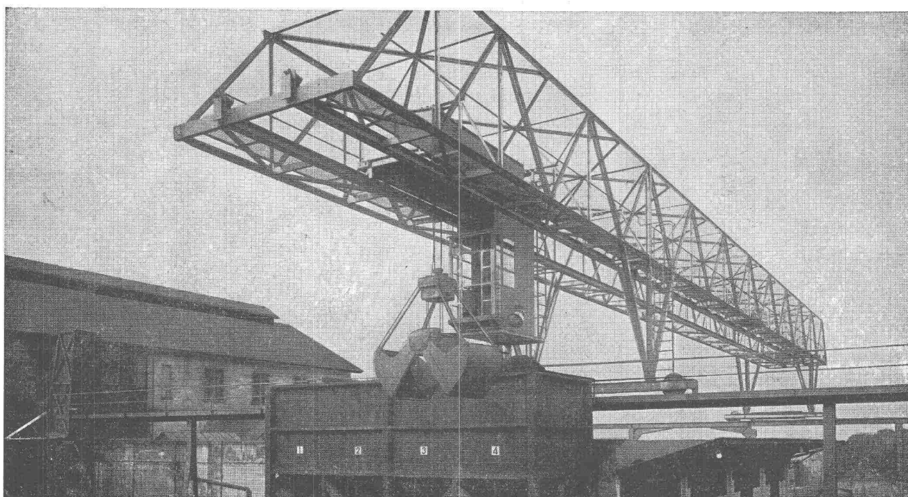
Verladebrücke in Schweisskonstruktion 2,5 t Tragkraft, 46 m Länge
