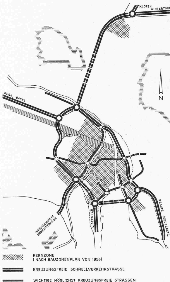
Bild 7. Schnellverkehrsstrasse nach Vorschlag des Bebauungs- und Quartierplanbüros der Stadt Zürich. Die sternförmig auf das Stadtgebiet einmündenden Autobahnen und wichtigen Vorortsverbindungen werden durch ein ringförmiges Schnellstrassen-Tangenten-System am Rande der City abgefangen. Diese Anordnung ist einleuchtend, wenn berücksichtigt wird, dass nur rund 20 % des einströmenden Verkehrs in die Kernzone wollen. Die übrigen 80 % werden durch das vorgeschlagene System folgerichtig von der City ferngehalten. Heute sind ausserdem 45 % des in die City einströmenden Verkehrs Durchgangsverkehr. Leistungsfähige Tangentenstrassen am Rande der Kernzone würden eine starke Entlastung für die City bringen. Die vorgeschlagene Konzeption hat zudem den Vorteil eines vom heutigen Strassennetz unabhängigen Trasses. Das erlaubt Sofortmassnahmen für die innerstädtischen Strassen und Knotenpunkte ohne jegliche Präjudiz.
