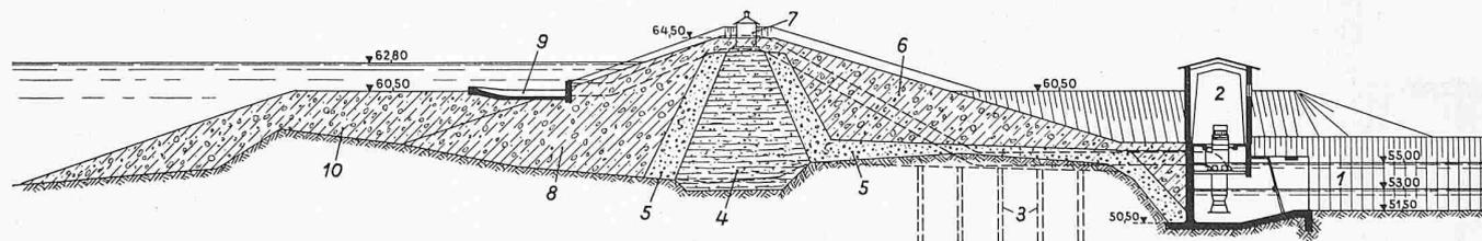
Bild 16. Querschnitt durch einen Schutzdamm mit Pumpstation, Masstab 1:600
