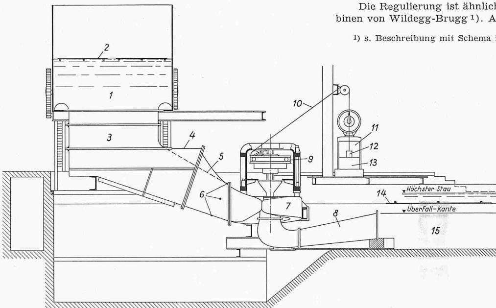
Bild 19. Prüfstand im Werk der Firma Bell in Kriens zur Vornahme der Abnahmeversuche an der Modellturbine
