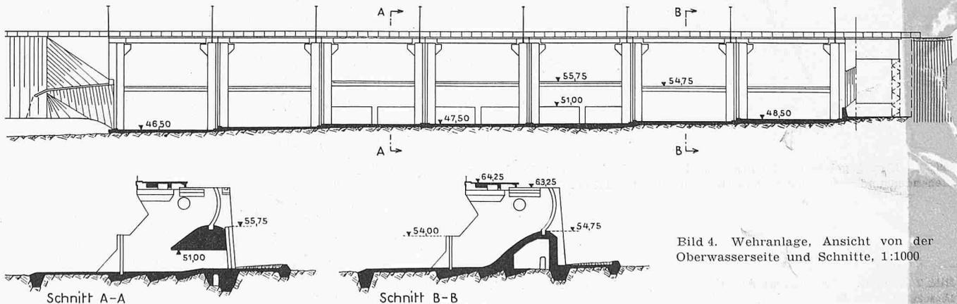
Bild 4. Wehranlage, Ansicht von der Oberwasserseite und Schnitte, 1:1000
