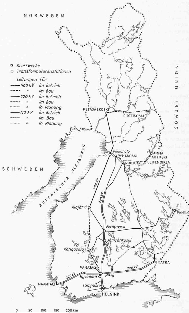
Bild 2 (rechts). Hochspannungs-Uebertragungsleitungen in Finnland, Masstab 1:8 000 000
