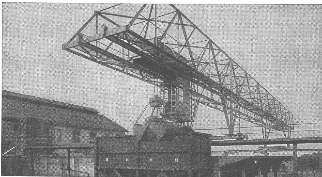
Verladebrücke in Schweisskonstruktion 2,5 t Tragkraft, 46 m Länge
