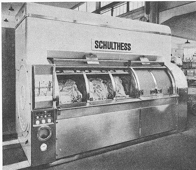
Bild 10. Grosser Waschautomat «Schulthess-Pullman» mit Trommel aus fünf Körpern, links die Lochkarte für die selbsttätige Steuerung
