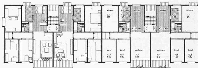
Grundriss des viergeschossigen Gebäudes. 1:400
