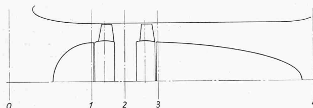
Bild 4. Zwei hintereinander geschaltete, gegenläufige Axialgitter (Hierzu Bild 8)
