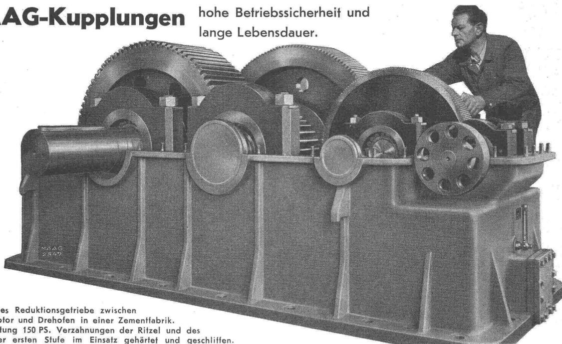
Dreistufiges Reduktionsgetriebe zwischen Elektromotor und Drehofen in einer Zementfabrik. Max. Leistung 150 PS. Verzahnungen der Ritzel und des Rades der ersten Stufe im Einsatz gehärtet und geschliffen.
