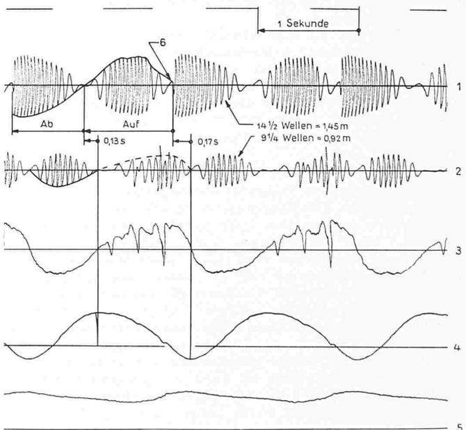
Bild 13. Typisches Diagramm eines Bohrvorganges bei 450 m Tiefe und Kurbelantrieb des Bohrmeissels
