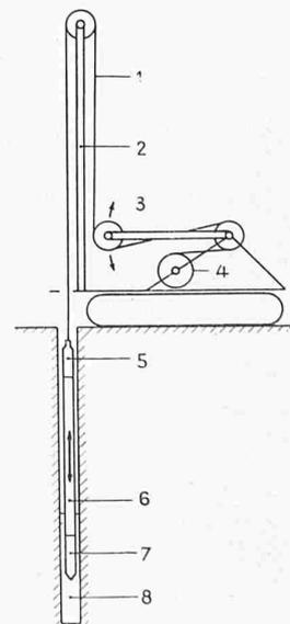
Bild 1. Hauptbestandteile eines Schlagbohrmeissels
