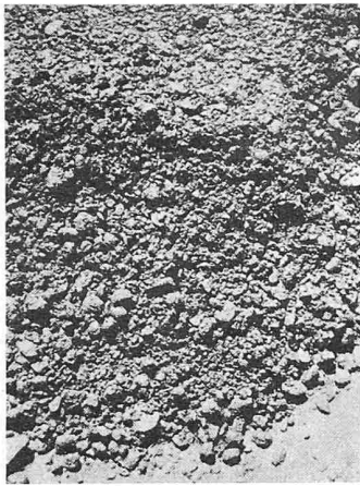
Fig. 14. Aspect d'un bon béton à son arrivée sur le barrage
