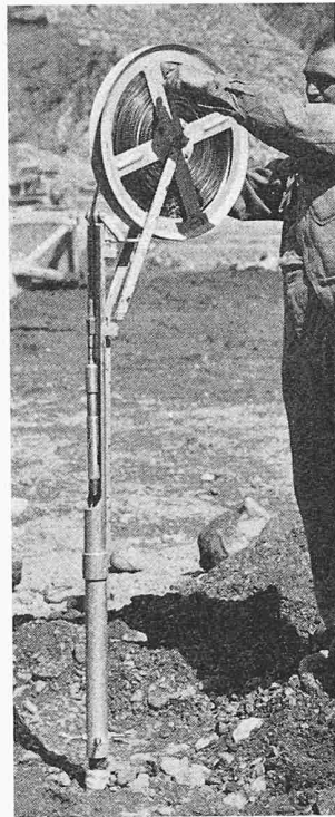
Bild 12. Auf dem Setzungspegel aufgesetzte Messeinrichtung. (Photo Brügger)
