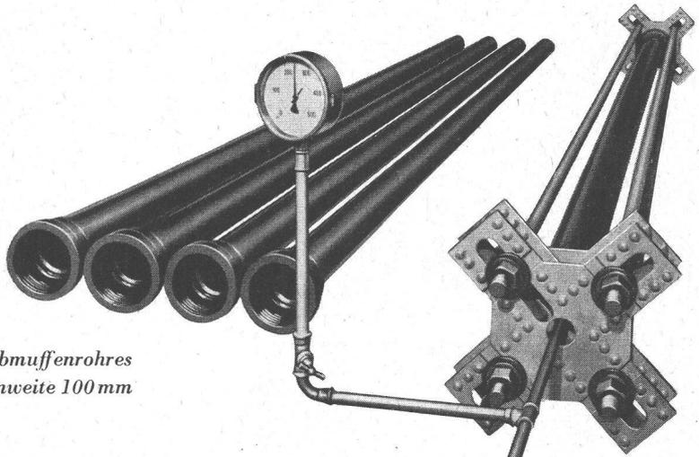
*Druckprobe eines ARENS-Schraubmuffenrohres
