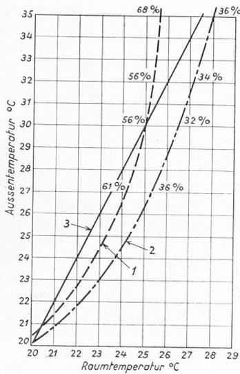
Bild 17. Gewünschter Zusammenhang zwischen Aussentemperatur und Raumtemperatur
