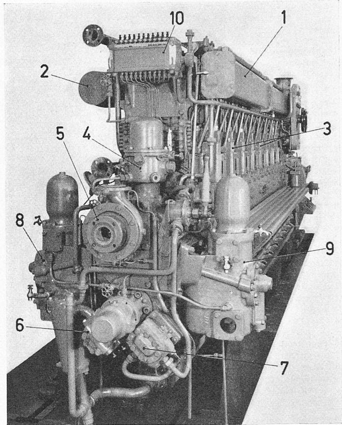
Bild 9. SLM-Schiffsdieselmotor Typ 8 VD 25 M. Blick auf Hilfsmaschinenseite
