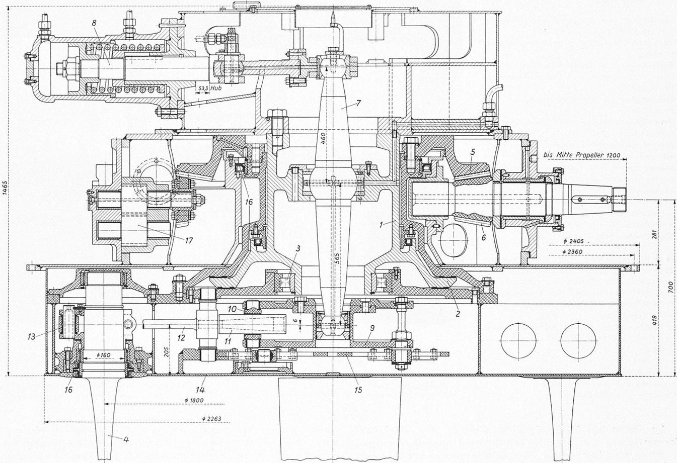
Bild 17. Längsschnitt durch Voith-Schneider-Propeller Typ 18 E, Massstab 1:15
