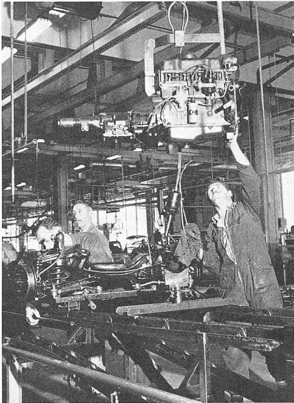
Bild 16 (links). Bereitstellen von Trieb- und Fahrwerk auf das Wagen-Montageband. Hier handelt es sich um einen Wagen europäischer Konstruktion mit selbsttragender Karosserie, also ohne Chassisrahmen.
