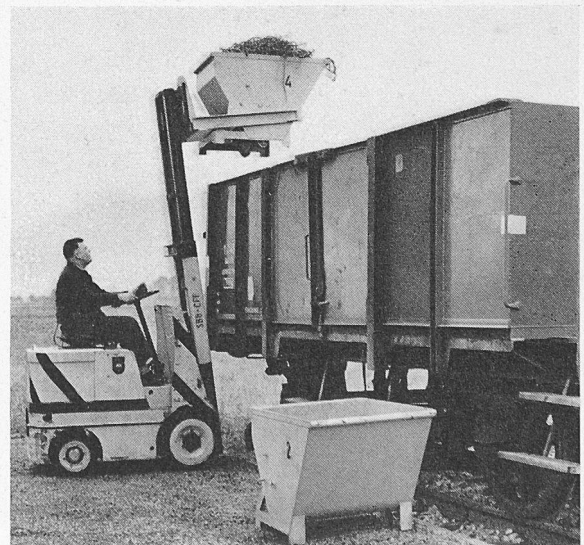
Bild 10. Frontstapler beim Auskippen eines Spänebehälters
