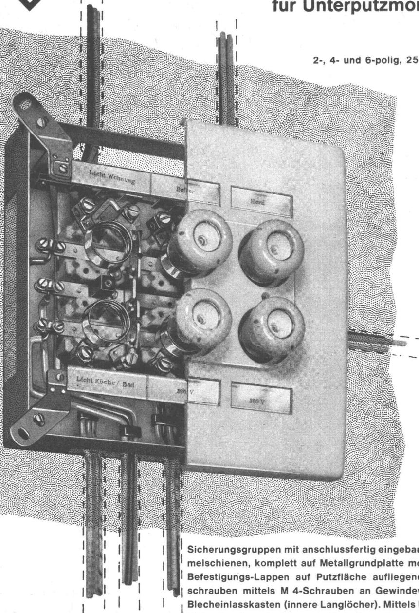
Sicherungsgruppen mit anschlussfertig eingebauten Sammelschienen, komplett auf Metallgrundplatte montiert. Befestigungs-Lappen auf Putzfläche aufliegend, festzuschrauben mittels M 4-Schrauben an Gewindewinkel im Blecheinlasskasten (innere Langlöcher). Mittels Halbrund-Holzschrauben 4x25 mm in Holzeinlasskasten (äussere Langlöcher).
