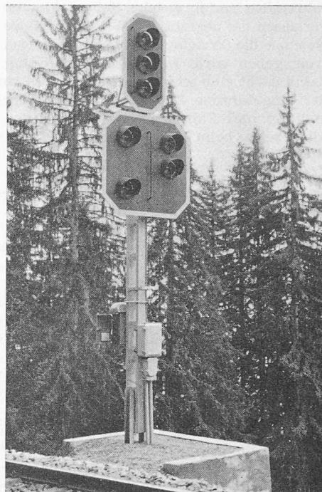
Bild 6. Einfahrtsignal D 1/3 mit angebautelem Vorsignal B*. An der Rückseite des Signalma- stes Telefonapparat zur allfälligen Verständigung zwischen Zugspersonal und Fahrdienst- leiter
