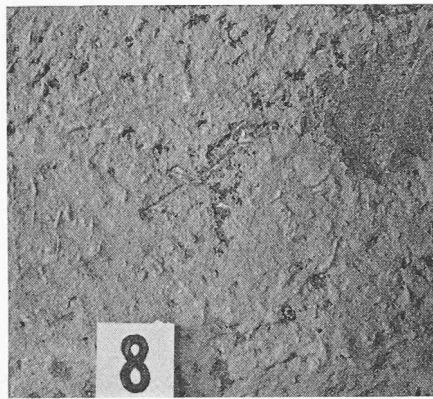
Nr. 8: Schalung aus ungehobeltem Holz, geölt. Sehr gute Haftung des ZS
