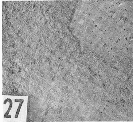
Nr. 27: Schalung Eisenplatte, geölt. Haftung des ZS nur mässig
