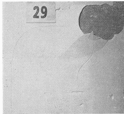
Nr. 29: Schalung geölte Eisenplatte. Gipsmörtel haftet nur mässig bis schlecht
