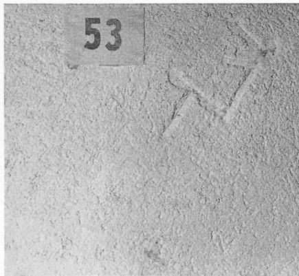
Nr. 53: Schalung ungehobeltes Holz, ungeölt. Plafonit haftet sehr gut
