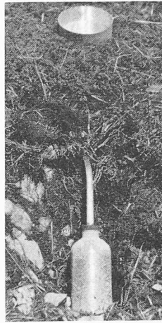
Bild 7. Niederschlagsmessungen mit hangparallelen Tagessammelern, bodenebener Auffangfläche, eingegrabener Trichter und unterirdischem Sammelgefäss
