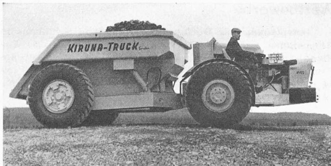
Bild 1. Diesel-Rückwärtskipper, Ladefähigkeit bis 21 t (15 m 3 )
