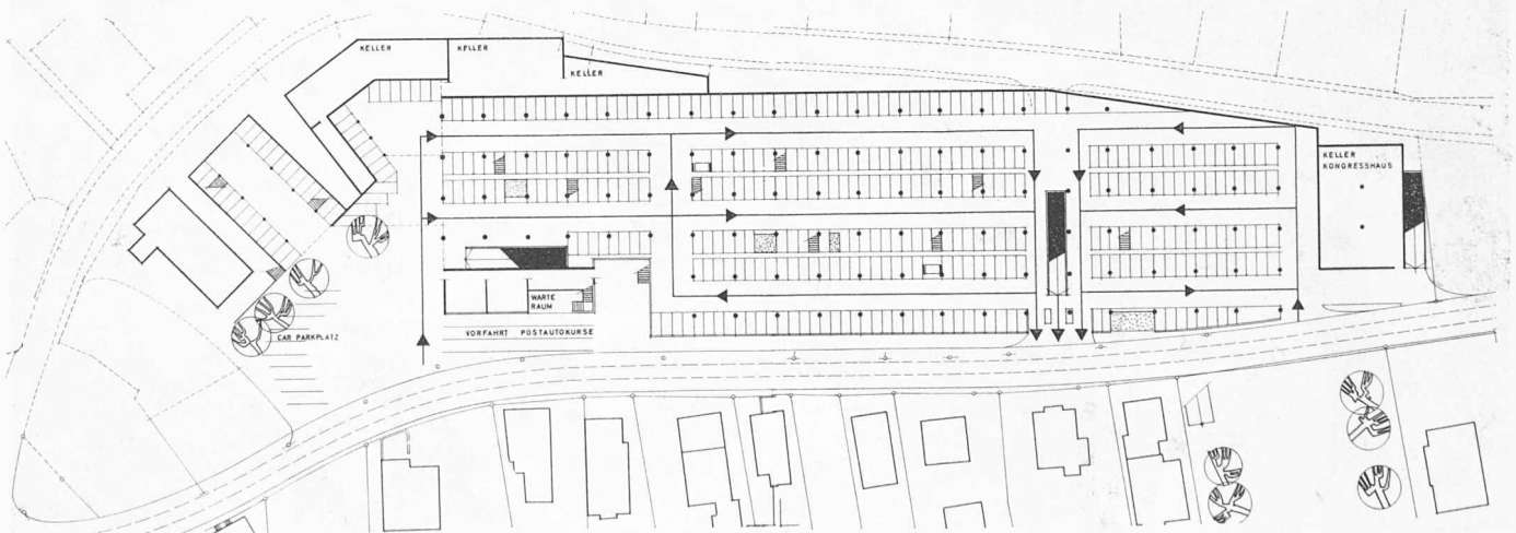
Bild 4. Das Parkgeschoss (1:2000) enthält 330 Abstellplätze für Kurzparker. Es wird bequem von der niveaugleichen Aeulestrasse aus erreicht. Ein- und Ausfahrten sind zusammengefasst. Darunter befindet sich nochmals ein Parkgeschoss kombiniert mit Kellerräumen, das für Dauerparker bestimmt ist
