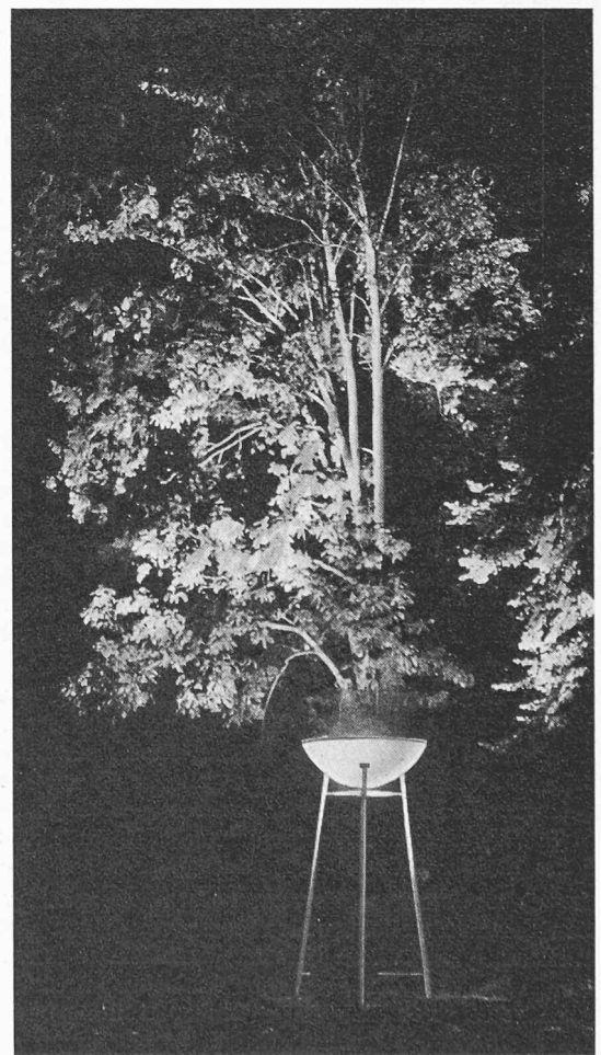
Bild 2 (rechts). Leuchtschale aus glasfaserarmiertem Polyester-Harz, 2 m Durchmesser, 0,70 m tief, auf unsymmetrischem Dreifuss, mit eingebautem Tragrahmen zur Aufnahme mehrerer Scheinwerfer verschiedener Funktion (Richtung, Farbe, Lichtstärken und Oeffnungswinkel) für die Anleuchtung von Baumgruppen und Gebäuden. Gleichzeitig zur Direkt-Beleuchtung von Wegen, Vorplätzen, Rasen- und Gartenpartien. Bauhöhe zwischen 3 und 7 m je nach Augenhöhe benachbarter Besucher, zur Vermeidung direkten Einblicks. Leicht grüne Einfärbung (Tagesfarbton) und Diffusionszusatz im Harz zur Erhöhung der Lichtstreuung. Lichtdurchlässigkeit \approx 60\%
