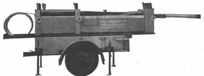
Seitenansicht der vollautomatischen Rinnenziehmaschine zur Herstellung von Dachrinnen in jeder gewünschten Länge direkt auf dem Bauplatz. Leistung 150 m per Stunde!
