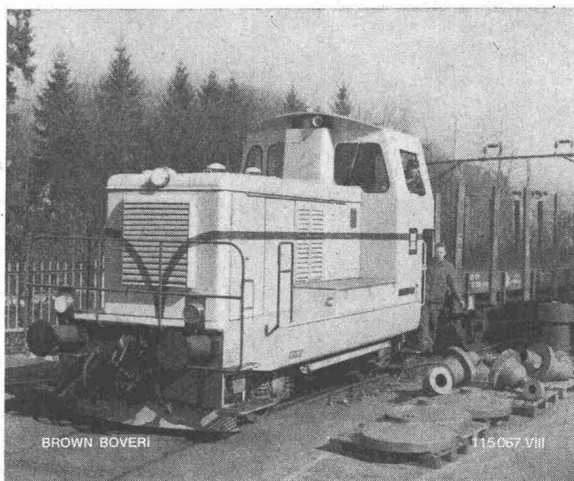
Dieselelektrische Industrielokomotive, 330 PS, 55 km/h, 11,7 t Anfahrzugkraft.
