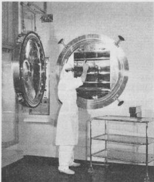
Bild 6. Vom Sterilraum aus zu bedienende Beschickungstür eines Gefriertrockners mit horizontaler Kammer
