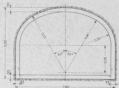
Bild 5. Tunnelquerschnitt 1:150
