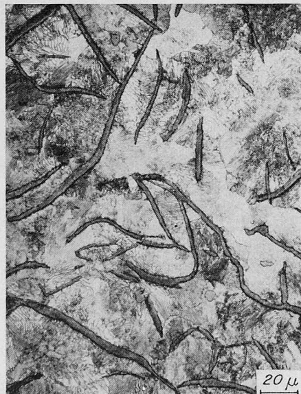
Bild 3. Gusseisen mit Lamellengraphit mit perlitischer Grundmasse (geätzt)
