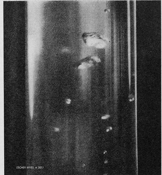
Bild 10. Versuchseinrichtung zur Ermittlung der Steiggeschwindigkeit einzelner Luftblasen unterschiedlicher Grösse bei verschiedenen statischen Drücken
