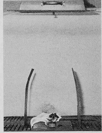
Bild 5b (rechts). Flammenbewegung bei Luftströmung von oben nach unten (Modellversuch)
