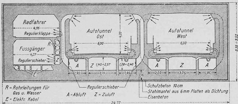
Bild 6. Querschnitt durch den Maastunnel in Rotterdam [16], 1:250
