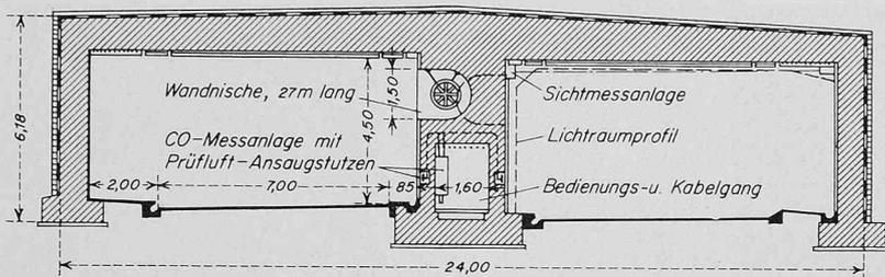
Bild 8. Querschnitt durch den Wallringtunnel in Hamburg [30], 1:250
