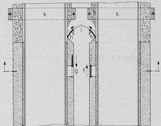
Bild 7. Vorschlag für die Gestaltung eines Kraftfahrzeugtunnels mit Sicherheitsvorrichtungen im Brandfall
