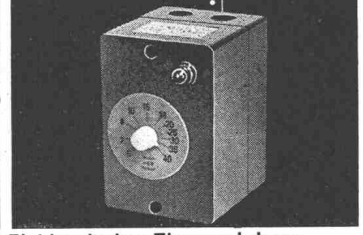
Elektronischer Thermostat zur automatischen Steuerung der Lüfter, gasgeschützt, 220 V~, 3 Amp. 8-40°C Auch für andere Zwecke einsetzbar, da gegen chem. Einflüsse geschützt
