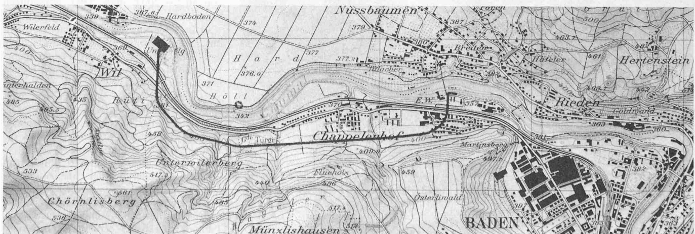
Bild 1. Lage des Stollens für den Zuleitungskanal zur Kläranlage der Region Baden. Die schwierigen Verhältnisse zwangen dazu, den Stollen auf dem kürzesten Weg durch die Schotterzonen in die oberflächennahe Molasse zu führen. Dies ergab eine Linienführung mit zahlreichen Kurven. Ausschnitt aus der Landeskarte 1:25 000 im Ausgabemassstab, reproduziert mit Bewilligung der Eidg. Landestopographie vom 8. März 1968
