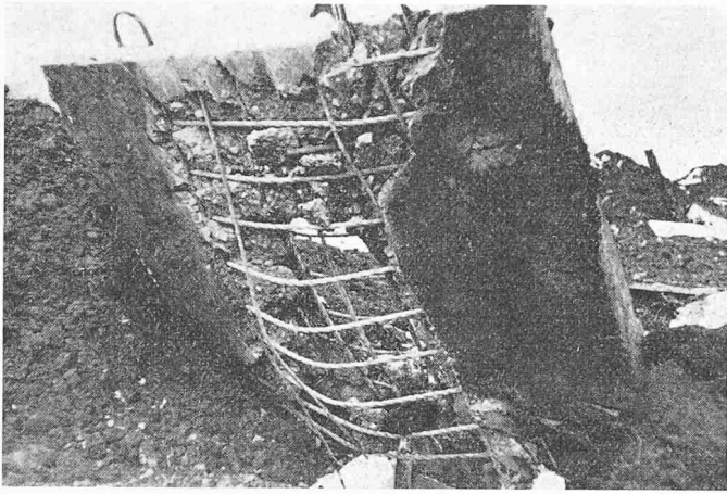
Platte B nach der Sprengung
