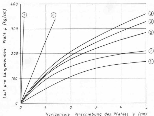
Bild 6. Last-Deformationskurven
