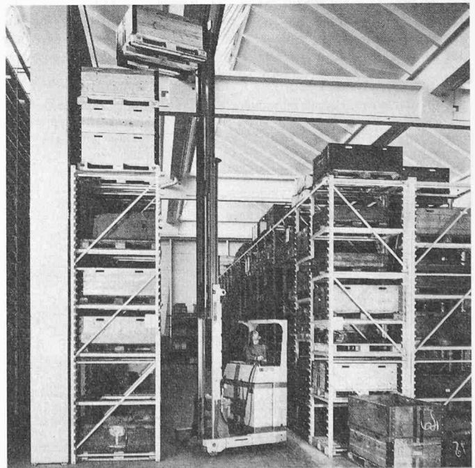
Bild 2. Der SIG-Lifter Modell RFQ 1602 t stapelt 1000 kg schwere Lasten in nur 2,10 m breiten Gängen auf 6 m Höhe. Das stufenlose Arbeiten eines Impulsfahrhalters erlaubt feinfühliges Manövrieren
