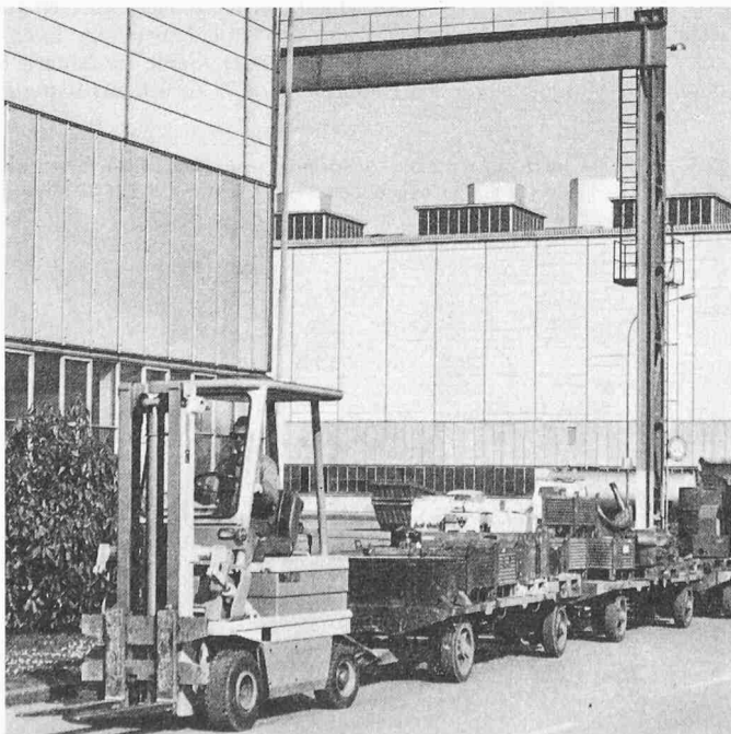
Bild 1. Ein SIG-Lifter Modell EFL 1580 t muss beim Schleppen langer Anhängerzüge oft lange Zeit mit verhaltener Geschwindigkeit fahren. Ein Impulsfahrshalter sorgt darum für gute Batterieausnutzung
