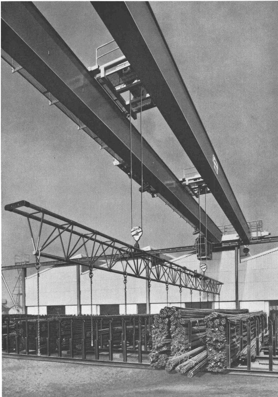
2-Träger-Laufkran, Tragkraft 10 t, Spannweite 33,5 m
