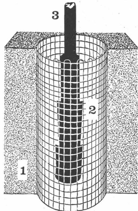
1 = Schnitt Beton 2 = Beton-Drahtkern 3 = Eisenstück, einzubetonieren
