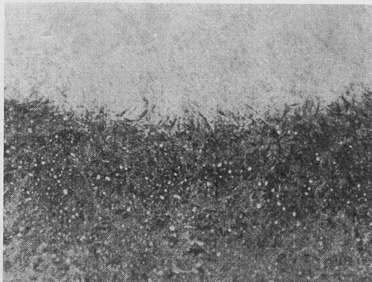
Bilder 6a und 6b. Mikroaufnahmen einer Schliiffprobe durch Krater in einem durch Stromdurchgang beschädigten Lagerring
