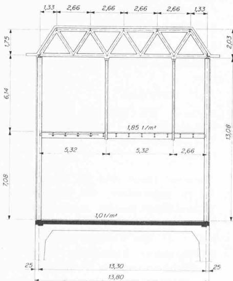
Bild 2. Querschnitt 1:300 durch das aufgestockte Gebäude
