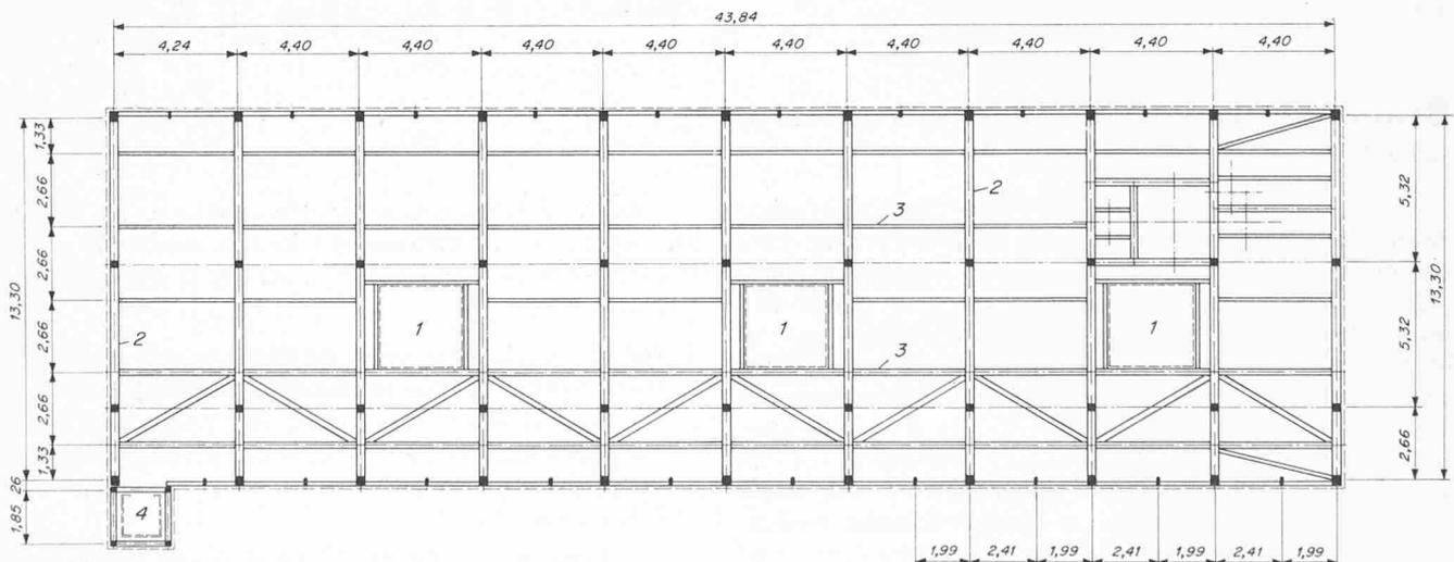
Bild 1. Grundriss 1:300 des Fachwerkes auf Dachhöhe
