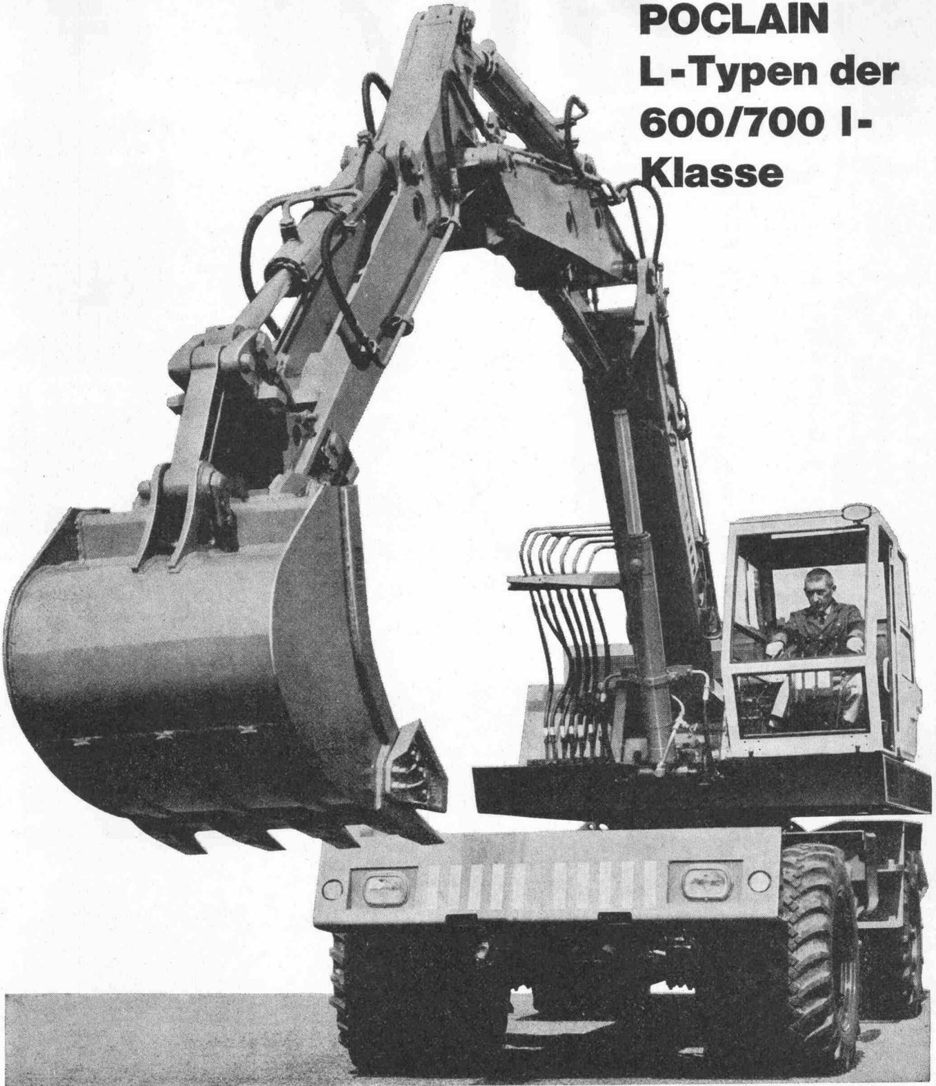
Die kräftigen Poclair L - Typen sind auf Raupen oder auf Pneu, mit dem äusserst beweglichen Dreipunkt-Fahrwerk oder dem geländegängigen Vierpunkt-Allradantrieb lieferbar.
