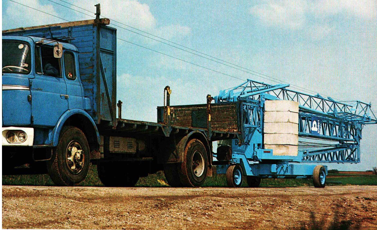
Vorne haben sich die 10 Ausgleichgewichtsblöcke nicht verschoben.
