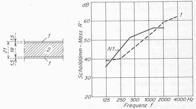
Bild 4. Verlauf des Schalldämm-Masses bei 18-cm-Isoliersteinwänden. Prüfschall Rosa-Rauschen; Empfangsfilter 1/1 Oktavband
