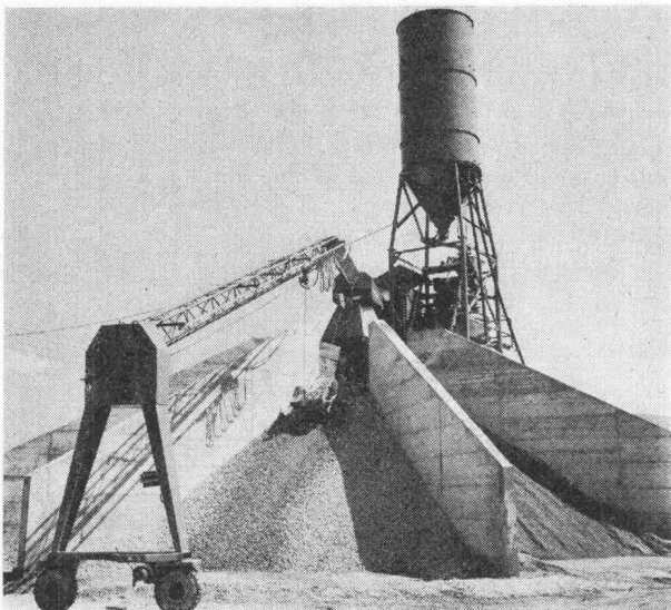
Zwangsmischer Raco-von Roll 750 I, Automatik-Schrapper Zyklus, Pfister-Kieswaage mit Fernanzeige, Frischbeton-Vorsilo 3,5 m 3 für Lastwagenbeschickung (Gravière de Courroux SA, Courroux)
