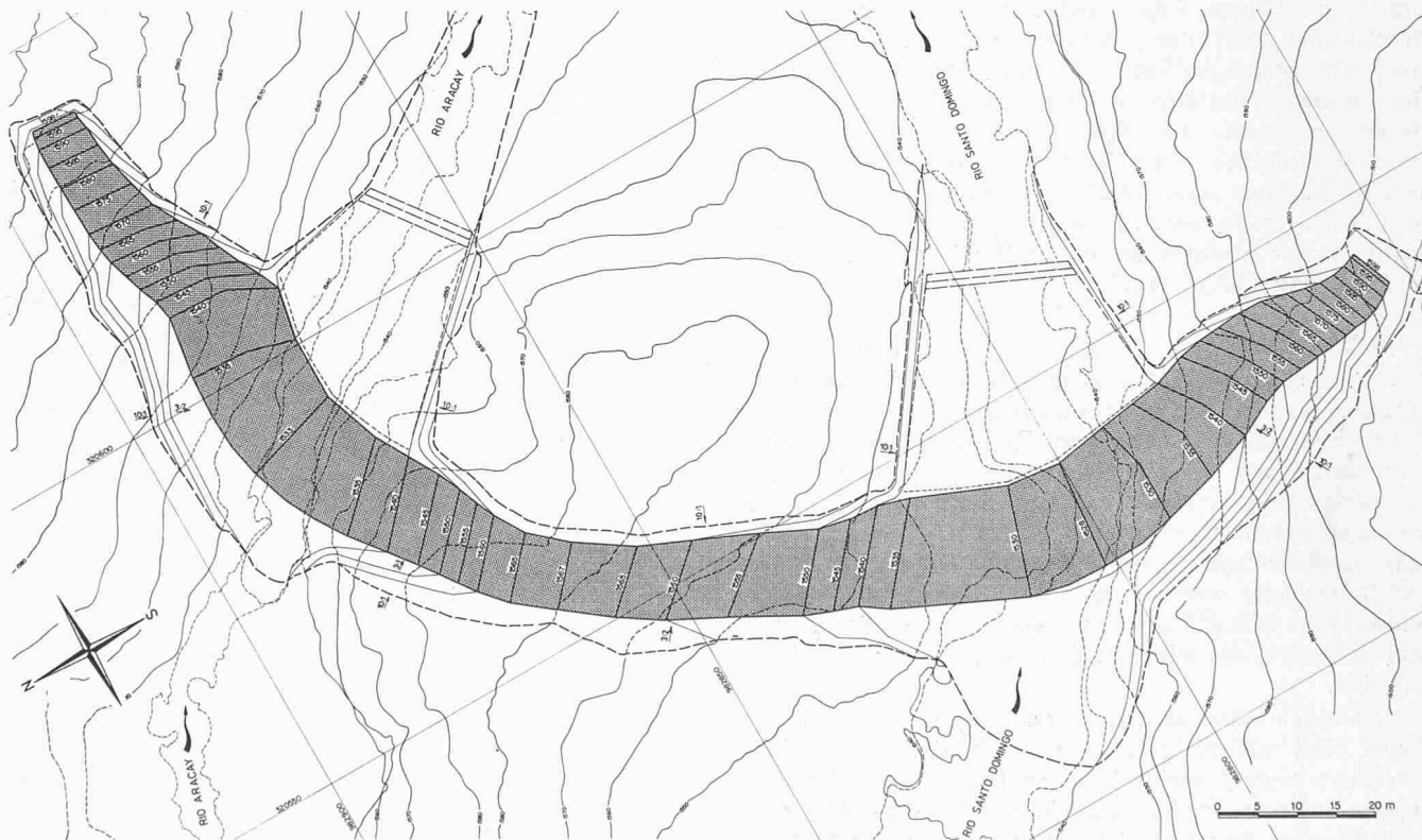
Bild 6. Staumauer Santo Domingo, Aushubplan 1 : 1000
