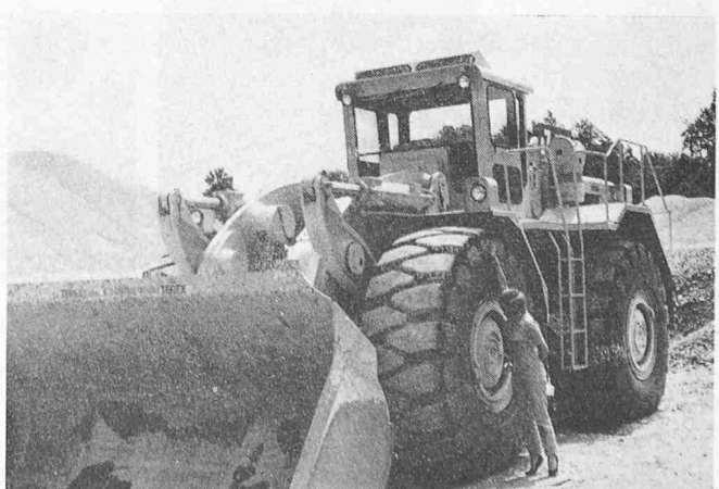
Bild 8. Gummibereifter Radlader Terex 72-81
