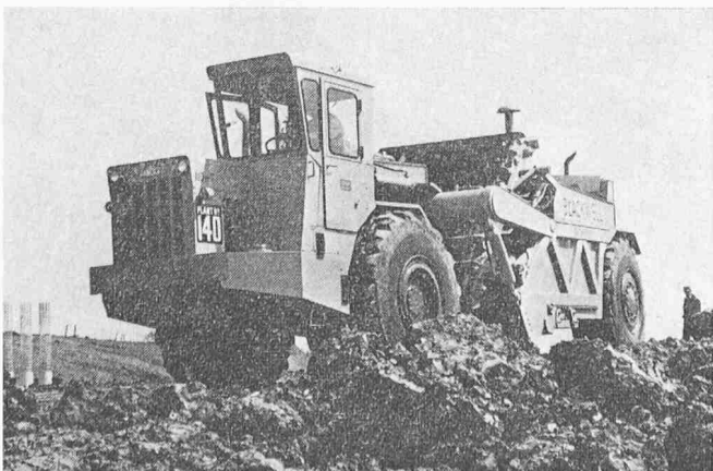
Bild 1. Schürflader Michigan 110 H-T mit Doppelmotor und Vierradantrieb
