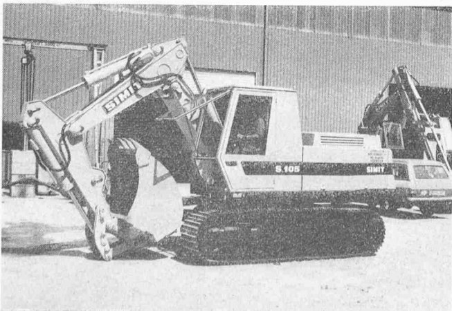
Bild 7. Ansicht des Hydraulik-Baggers Simit S.105 . Gut erkennbar ist der dreiteilige Ausleger
